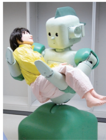
▲触覚を用いて人を抱き上げるロボット「RI-MAN」の研究・開発 (フロンティア研究システム)
