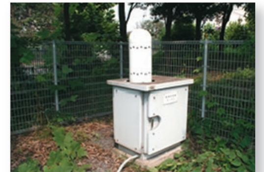
空気中の放射線量を測定するモニタリングポスト。
