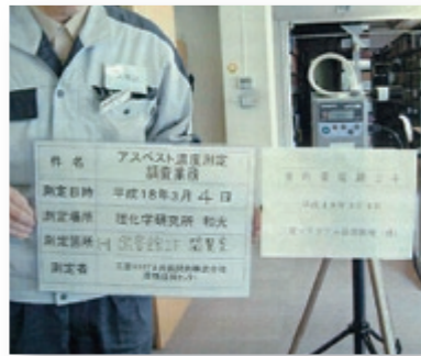
アスベスト調査(室内環境における濃度測定)の様子。
