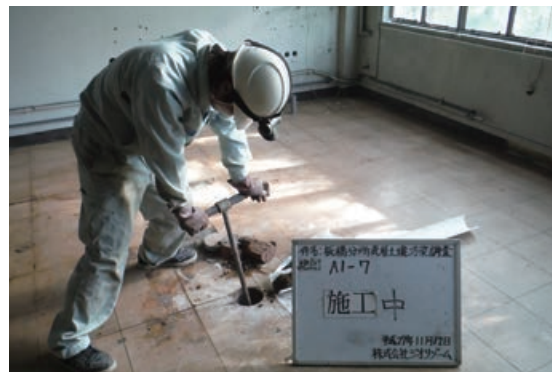
土壤汚染調査のための土壌採取
