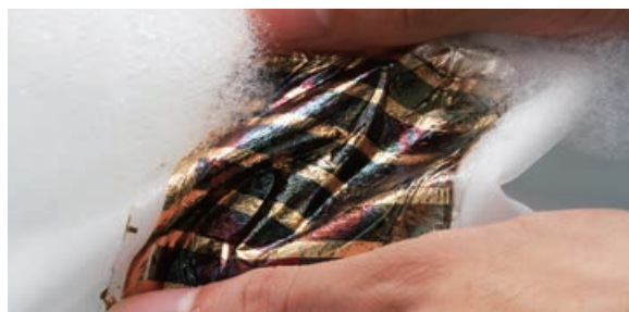
有機薄膜太陽電池を貼り付けた白いワイシャツを洗濯している。
