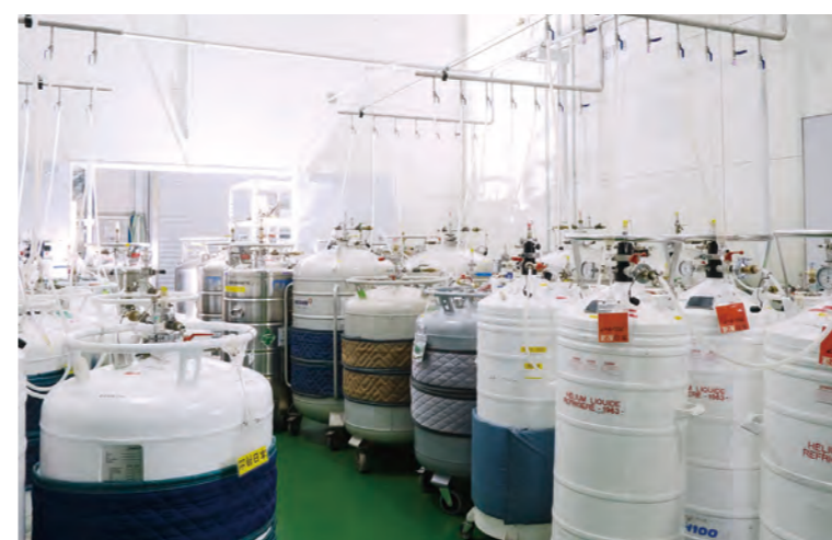
図2 リサイクルされ、再度配給されるのを待つ液体ヘリウム
