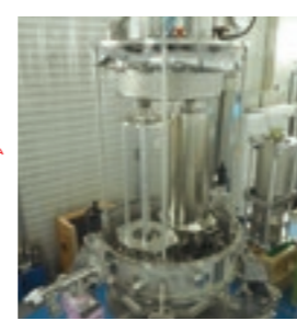
組み立て中の超伝導線型加速器プロトタイプ
