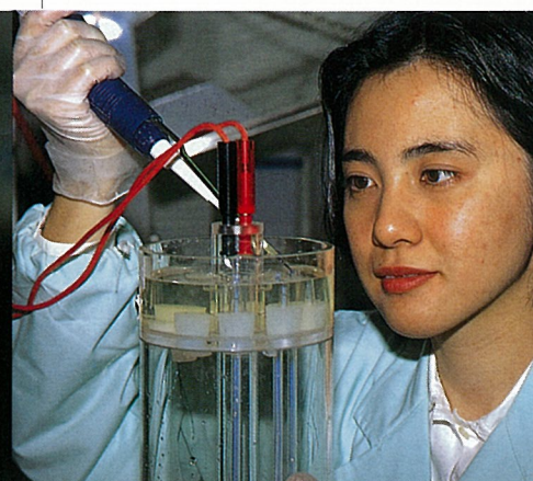
アガロース電気泳動装置への試料の注入
