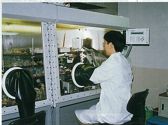
写真 2 酸素と湿気を完全除去したキャビネット
