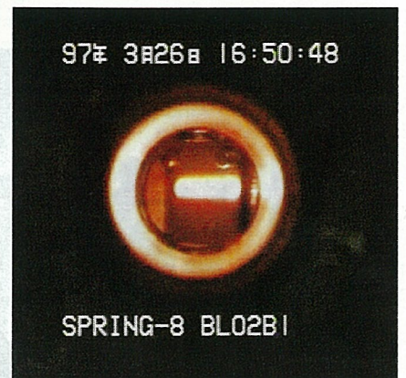
蓄積リングから発生した放射光（中心の白い長方形が放射光）
