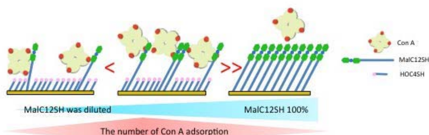
図 1. 水酸基末端チオール（スペーサー分子）とレクチン認識分子（糖鎖）との混合膜上でのレクチン（Con A）認識のモデル図。
