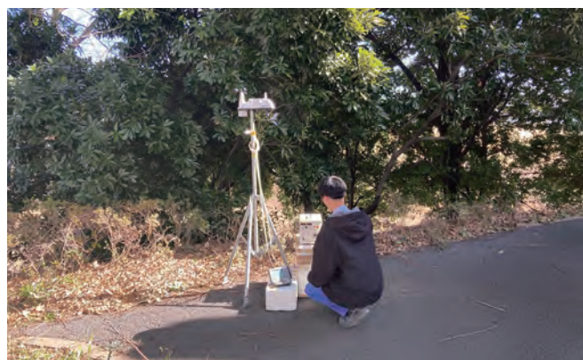
有害大気汚染物質測定の様子
