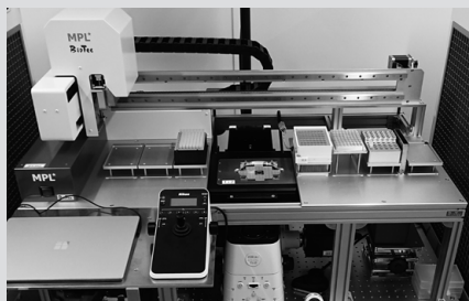
新しい検査法による自動検査装置(open-SATORI装置)
