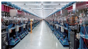
SACLA内部 真空封止アンジュレータ
