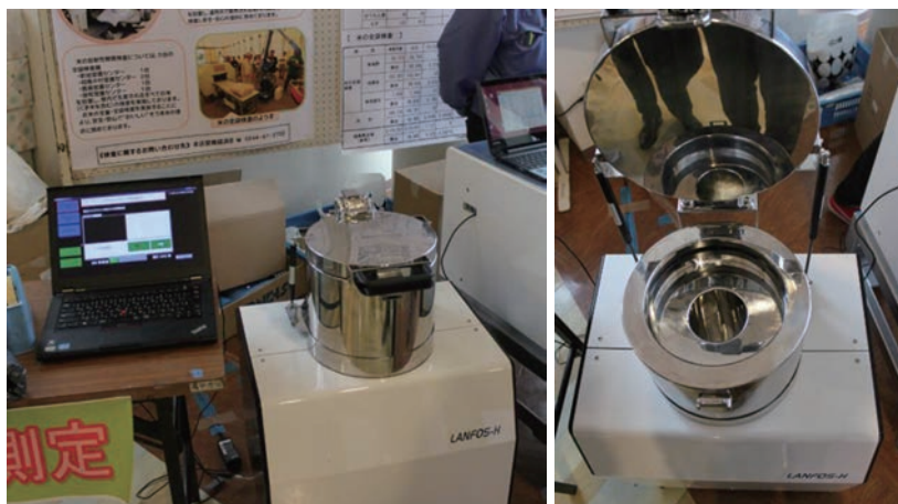
図5 LANFOSを使った農作物の放射能測定試験（福島県南相馬市で2014年11月1-2日開催のJAまつりにて）装置のサイズは高さ83cm×奥行45cm
