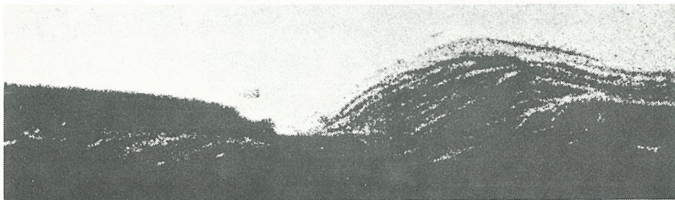
(2) Zn, K\alpha -X線像, 白い部分にZnが存在する
