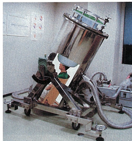
図1 実際に作成した全頭型 SQUID 脳磁界計測装置
