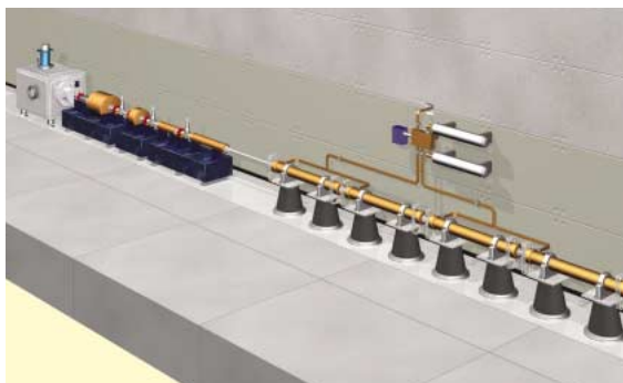
図1 XFEL線型加速器完成予想図 XFELは、電子を出す「電子銃」、その電子を加速し電子ビームをつくる「線型加速器」、そのビームからXFELを生み出す「アンジュレータ」から成る全長約1kmの装置となる。
