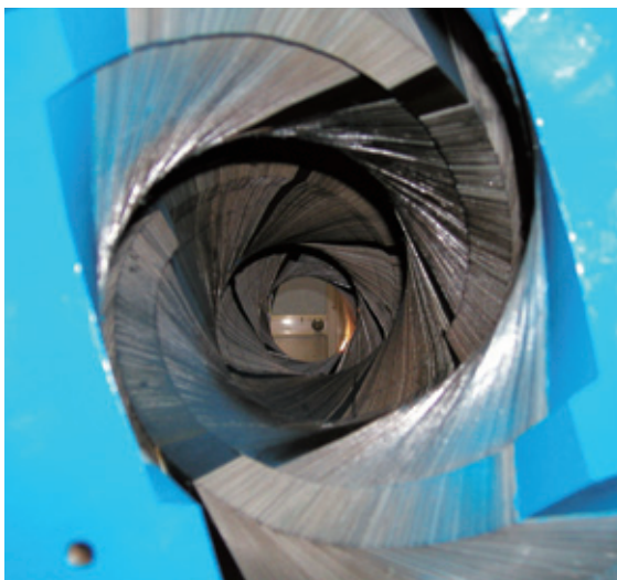
図 RHIC前段加速器に設置されたサイベリアン・スネーク磁石
