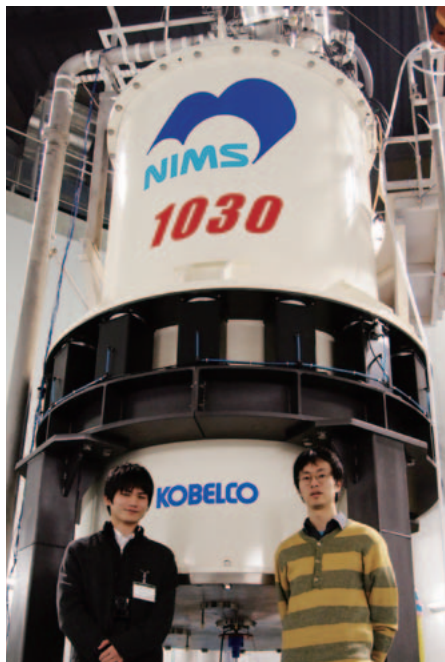
図2 第一世代高温超伝導ワイヤのコイルを組み込んだ1.03GHzのNMR装置
