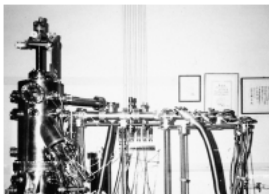
カイス (同軸型直衝突イオン散乱分光装置)
