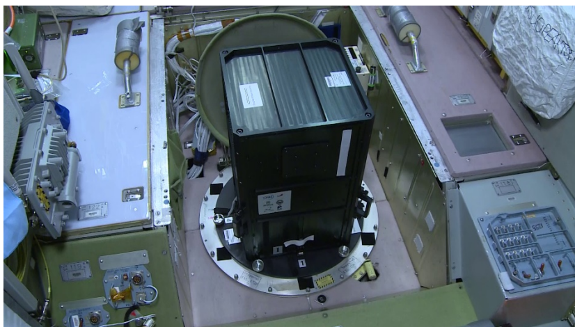
図 国際宇宙ステーションのロシアモジュールの窓に取り付けられたMini-EUSO
