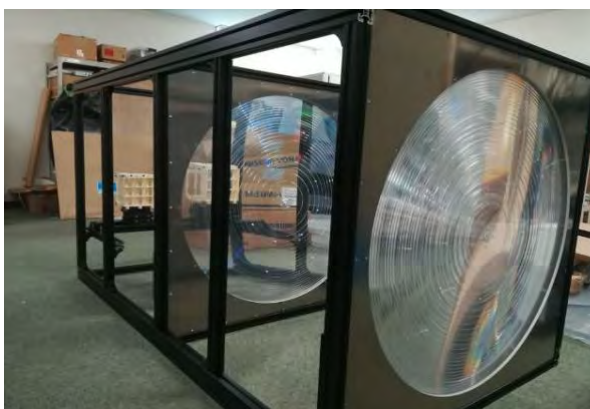
(図) 広角望遠鏡フレームの設計図(左)とレンズを組み込んだ望遠鏡フレームの写真(右)
