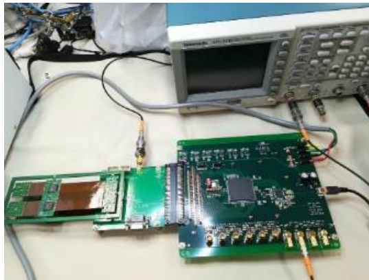
図2：アナログデジタル変換ボード(1枚、128ch分)(左)とその動作試験セットアップ(右)
