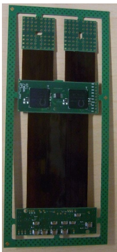
図2：アナログデジタル変換ボード(1枚、128ch分)(左)とその動作試験セットアップ(右)
