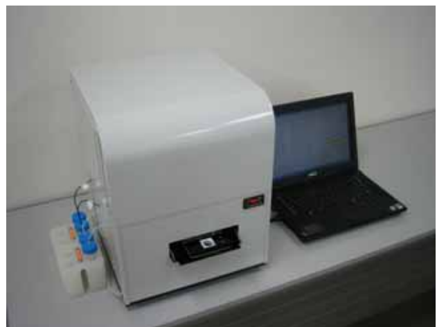
図1 微量サンプル、迅速、網羅的に測定可能な全自動マイクロアレイチップ測定機
