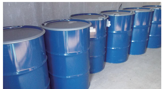
漏洩対策などの措置を行い保管していたPCB含有廃棄物
