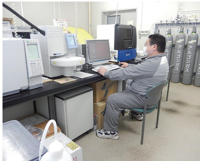
GC-MSによる実験排水中の有機化合物の分析
