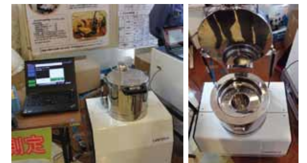
LANFOSを使った農産物の放射能測定試験(福島県南相馬市で2014年11月1・2日に行われたJAまつりにて)。装置のサイズは高さ83cm×幅58cm×奥行45cm。
