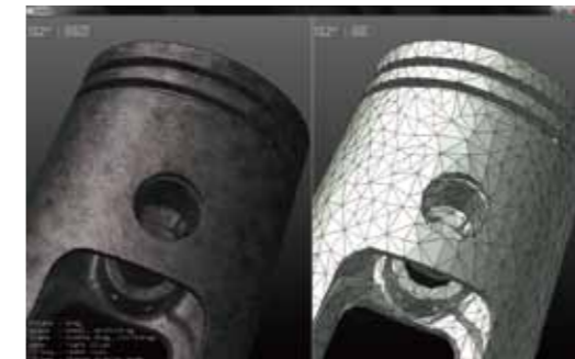
簡略化実行前: X線CT装置から得られたデータをもとにポリゴンメッシュを作成。約66万個の小さな三角形で構成されている。(写真左) 簡略化実行後: 今回開発したソフトウェアにより、三角形数を100分の1に削減した。簡略化前の形状を精密に表現できている。(写真右)
