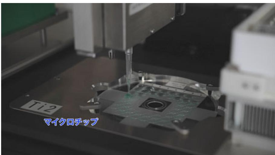
その検体を装置にセットすると、自動的に試薬と混ざり、マイクロチップへ流れます。
