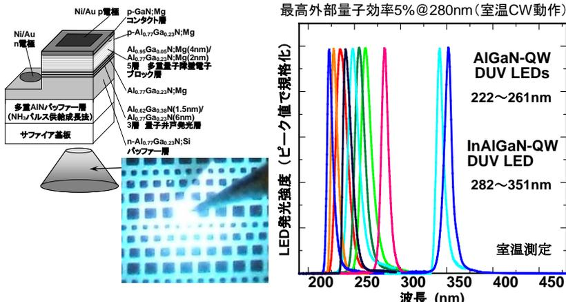
図3. 実現した AlGaIn 系半導体深紫外 LED (波長 222-351nm) の構造と動作スペクトル
