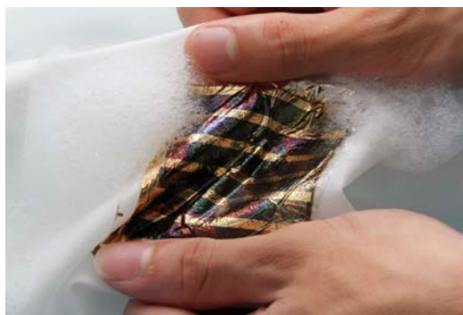
図1. 衣服上に貼り付けた超薄型有機太陽電池の洗濯写真
